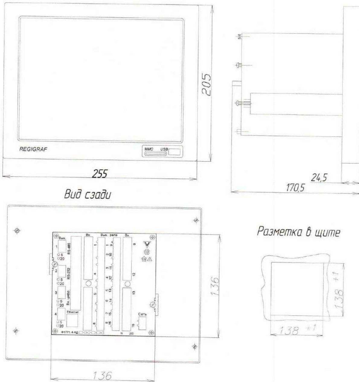
Рисунок 1 – Габаритный чертёж прибора и вырез в щите
