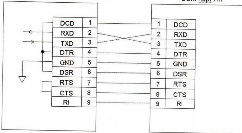
Рисунок 61 – Схема подключения к ПК по интерфейсу RS232
