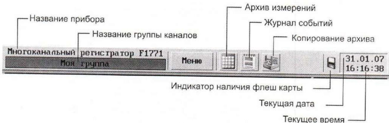
Рисунок 3 – Панель в верхней части экрана
