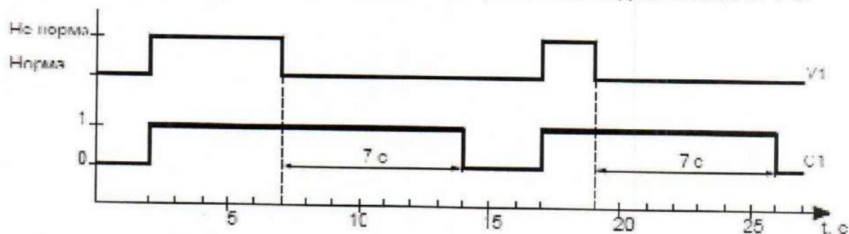
Рисунок 41 – График работы события, для которого задана длительность
