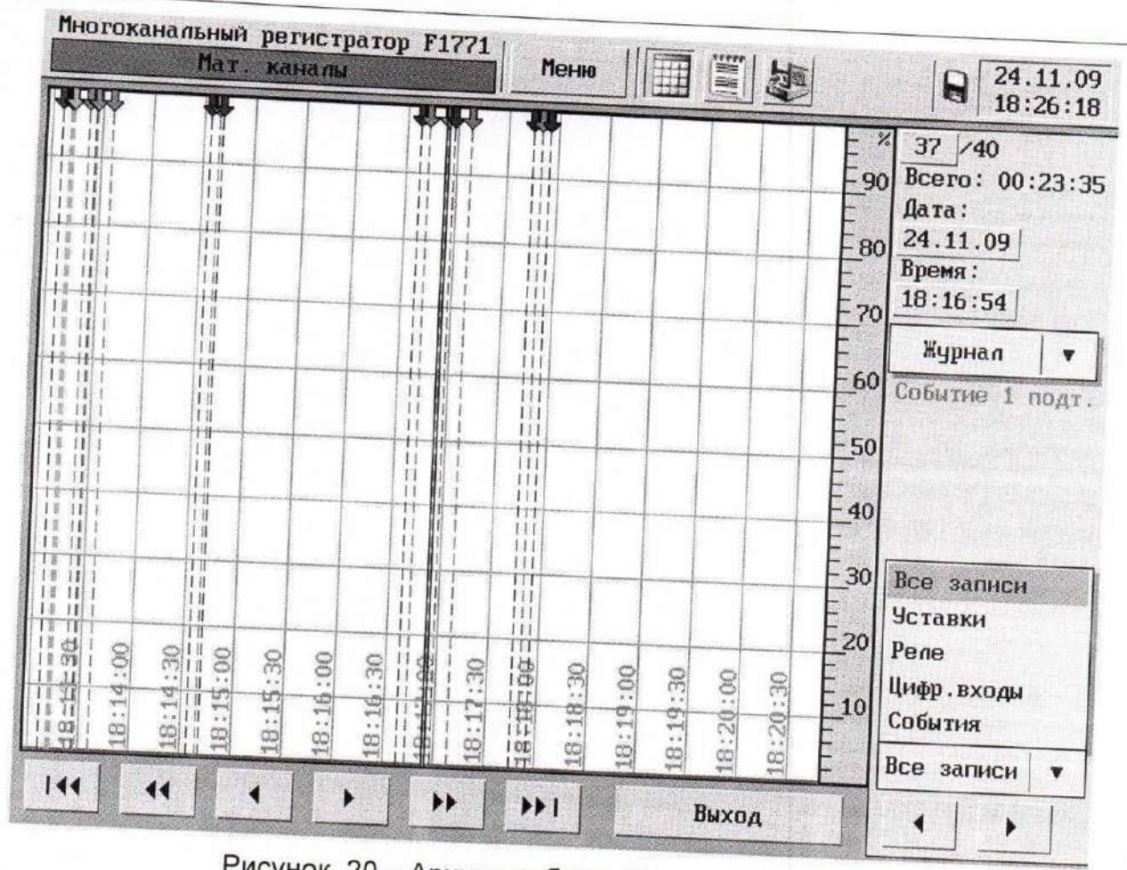
Рисунок 20 – Архив прибора. Режим «Журнал»
