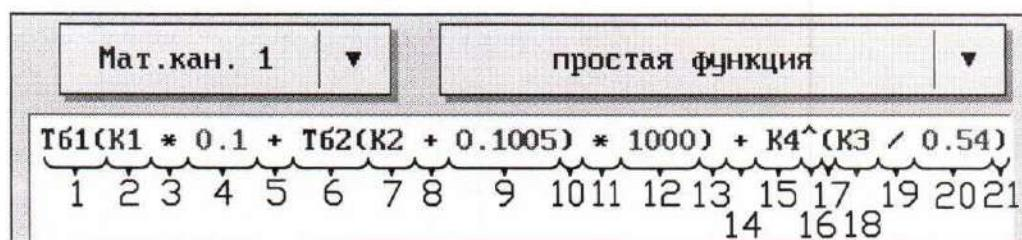
Рисунок 48 – Пример подсчета числа аргументов и операторов МК
